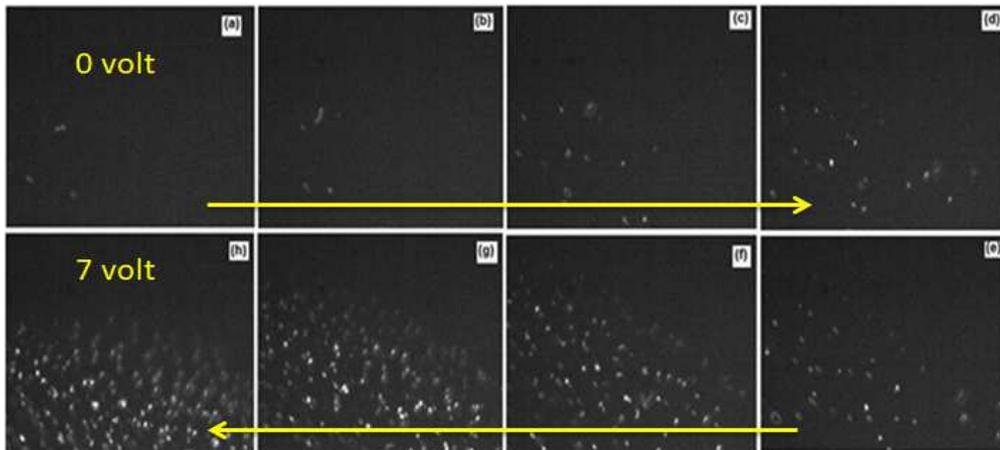
**Figure 6:** Stable carbon dust cloud of different cathode biasing voltages (a) 0 volt (b) 1.0 volt (c) 2.0 volt (d) 3.0 volt (e) 4.0 volt (f) 5.0 volt (g) 6.0 volt (h) 7.0 volt.
